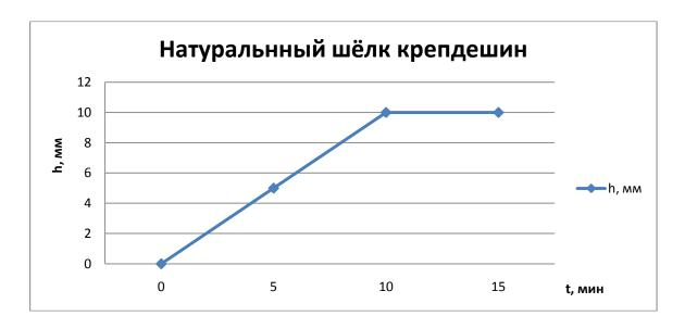
Максимальная высота подъема воды в ткани из натурального шелка крепдешина составляет  $h_{\text{макс}}=10$  мм. Время подъема на данную высоту t=10 мин. Средняя скорость подъема на максимальную высоту равна:  $\langle \vartheta \rangle = \frac{h_{\text{макс}}}{t} = \frac{10 \text{ мм}}{10 \text{ мин}} = 1 \frac{\text{мм}}{\text{мин}}.$
