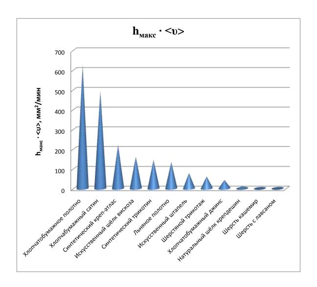
Таким образом, в результате проведенного эксперимента было установлено, что из выбранных для исследования нами тканей выше всего вода поднялась в хлопчатобумажном полотне  $h_{\text{макс}} = 280$  мм.
