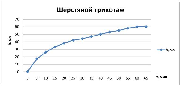
Максимальная высота подъема воды в ткани из шерстяного трикотажного полотна составляет  $h_{\text{макс}}=60$  мм. Время подъема на данную высоту t=60 мин. Средняя скорость подъема на максимальную высоту равна:
