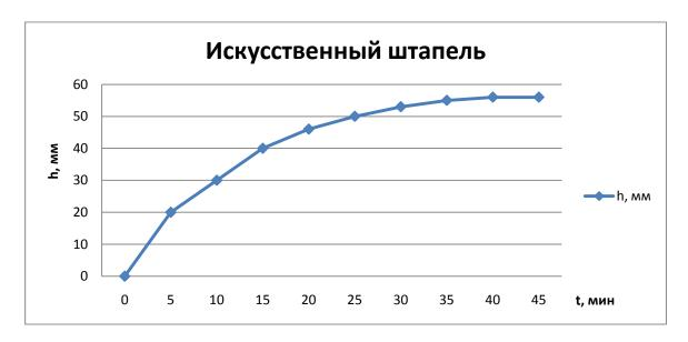
Максимальная высота подъема воды в ткани из искусственного штапеля составляет  $h_{\text{макс}} = 56$  мм. Время подъема на данную высоту t = 40 мин. Следовательно, средняя скорость подъема на максимальную высоту равна:
