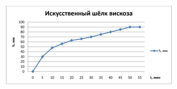
Максимальная высота подъема воды в ткани из искусственного шелка вискоза составляет  $h_{\text{макс}} = 90$  мм. Время подъема на данную высоту t = 50 мин. Средняя скорость подъема на максимальную высоту равна:  $\langle \vartheta \rangle = \frac{h_{\text{макс}}}{t} = \frac{90 \text{ мм}}{50 \text{ мин}} = 1,8 \frac{\text{мм}}{\text{мин}}.$
