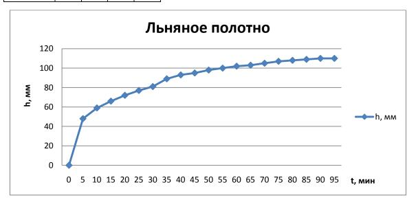
Максимальная высота подъема воды в ткани из льняного полотна составляет  $h_{\text{макс}}=110$  мм. Время подъема на данную высоту t=90 мин. Следовательно, средняя скорость подъема на максимальную высоту равна:  $\langle \vartheta \rangle = \frac{h_{\text{макс}}}{t} = \frac{110 \text{ мм}}{90 \text{ мин}} = 1,22 \frac{\text{мм}}{\text{мин}}.$
