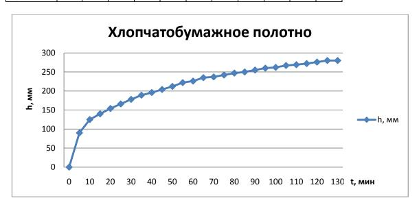
Максимальная высота подъема воды ткани ИЗ хлопчатобумажного полотна составляет  $h_{\text{макс}} = 280 \text{ мм}$ . Время подъема на данную высоту t = 125 мин. Следовательно, средняя скорость подъема на максимальную высоту равна:  $\langle \vartheta \rangle = \frac{h_{\text{макс}}}{t} = \frac{280 \text{ мм}}{125 \text{ мин}} = 2,24 \frac{\text{мм}}{\text{мин}}.$
