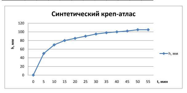
Максимальная высота подъема воды в ткани из синтетического креп-атласа составляет  $h_{\text{макс}} = 105$  мм. Время подъема на данную высоту t = 50 мин. Средняя скорость подъема на максимальную высоту равна:
