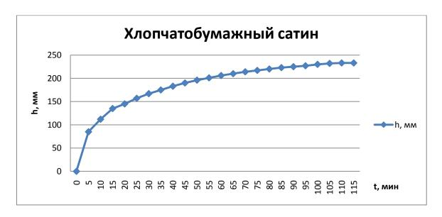
Максимальная высота подъема воды в ткани из хлопчатобумажного сатина составляет  $h_{\text{макс}}=233$  мм. Время подъема на данную высоту t=110 мин. Средняя скорость подъема на максимальную высоту равна:
