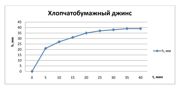
Максимальная высота подъема воды в ткани из хлопчатобумажного джинса составляет  $h_{\text{макс}} = 39$  мм. Время подъема на данную высоту t = 35 мин. Следовательно, средняя скорость подъема на максимальную высоту равна:
